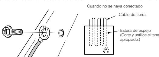
**Precaución:** La sección del terminal está asegurada por la estera de espejo.
