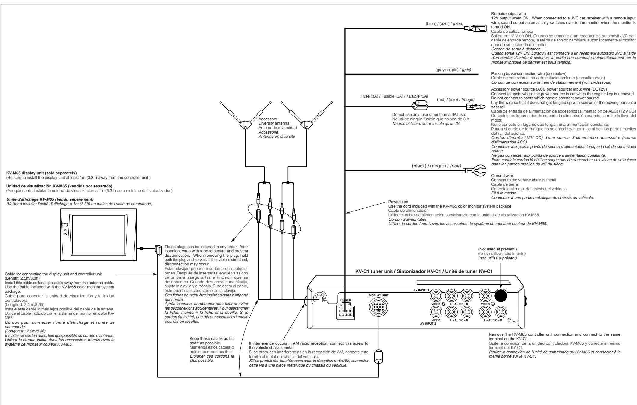
**Connecting the parking brake connection wire / Conexión del cable de conexión del freno de estacionamiento / Raccordement du câble de connexion du frein de stationnement.**
