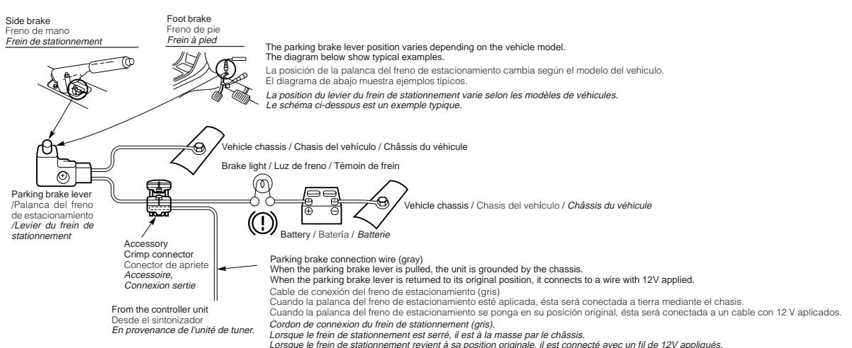
**How to connect the crimp connector / Cómo conectar el conector de apriete / Raccordement de la connexion sertie.**
